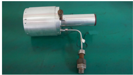
图 12 双脉冲发动机试验装置 Fig. 12 Dual-pulse motor test equipment
